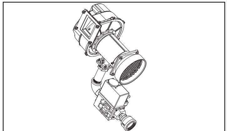
**Ensemble de soufflante à soupape à gaz**
