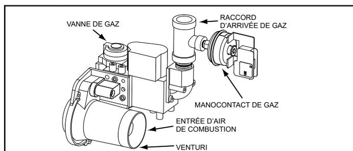
Figure 62. Ensemble vanne de gaz/venturi - Vue de côté
