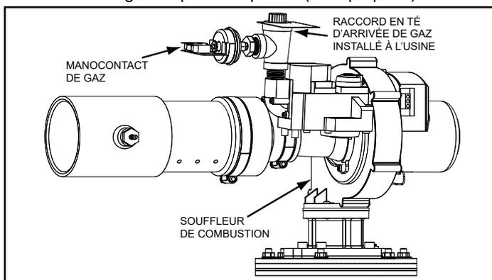
Figure 55. Raccordement de la conduite d'arrivée de gaz
