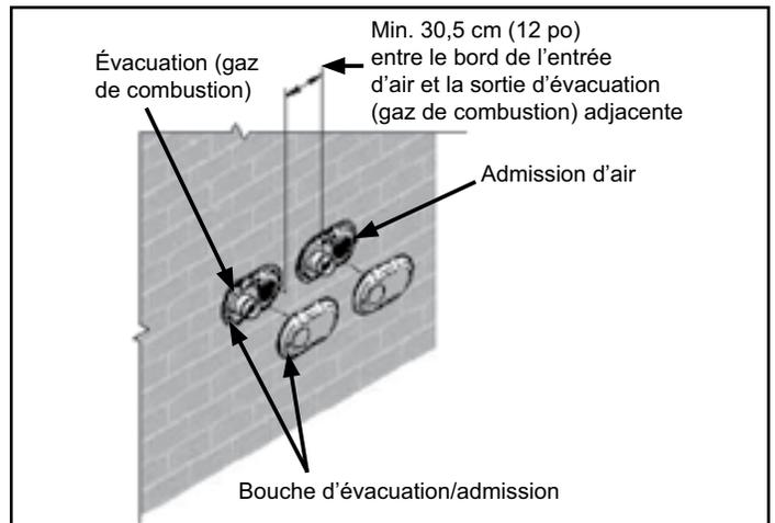
Figure 41. Dégageur de plusieurs bouches d'extrémité compactes
