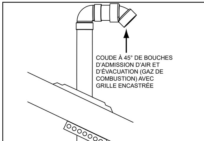
**Figure 21. Extrémités standard fournies par l'usine**
