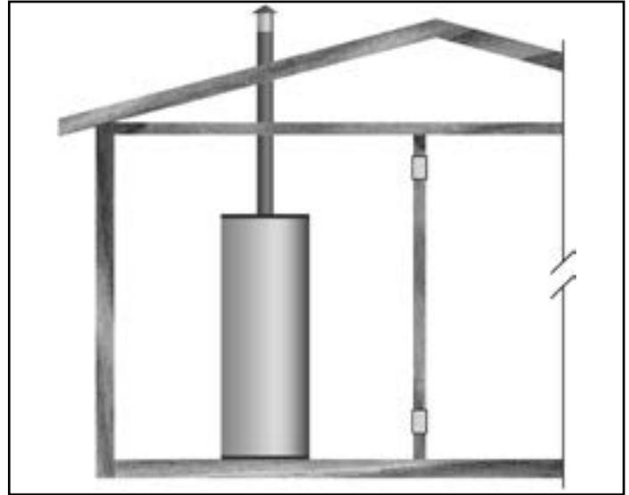
Figure 13. Deux ouvertures permanentes
