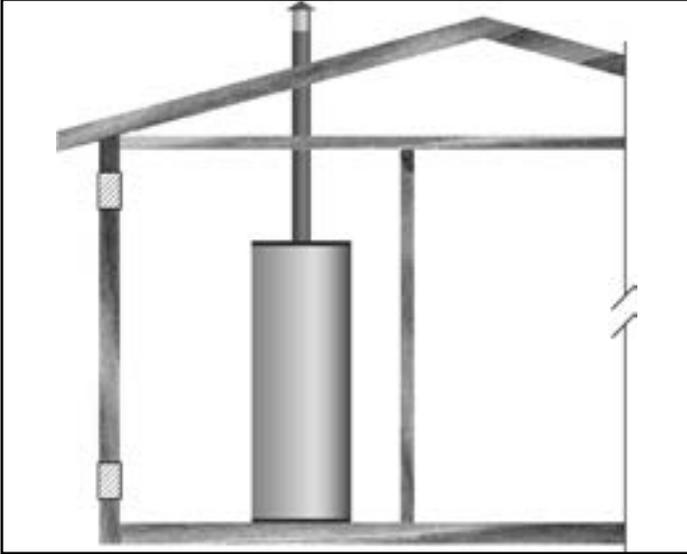
Figure 9. Air extérieur à travers deux ouvertures
