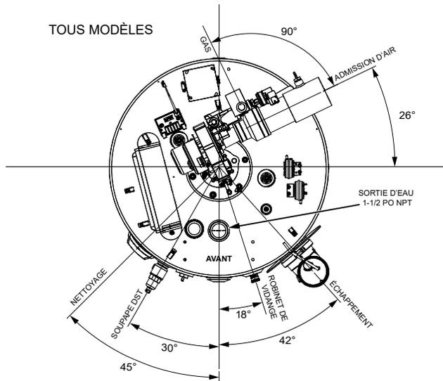
\* La ligne médiane de la sortie d'eau sur le dessus des chauffe-eau se trouve à environ 18 cm (7 po) du bord avant du chauffe-eau.
