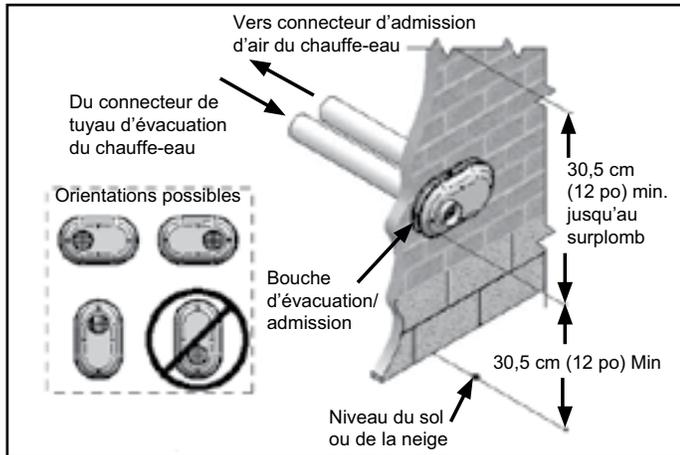
Figure 40. Dégageur d'une bouche d'extrémité compacte
