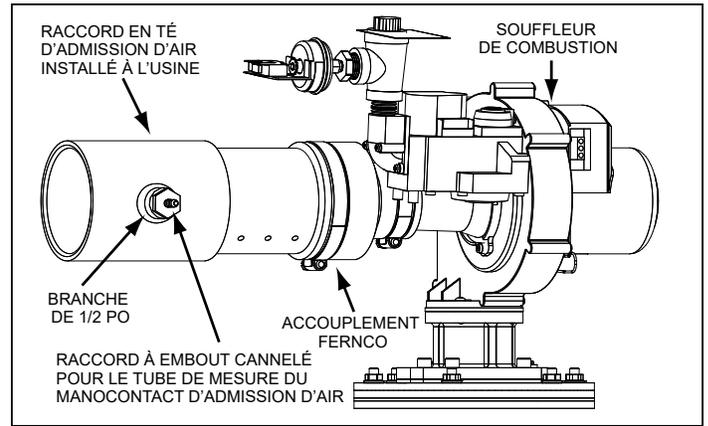
**Figure 14. Ensemble souffleur de combustion**
