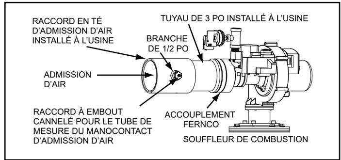
**Figure 19. Raccordement d'admission d'air**
