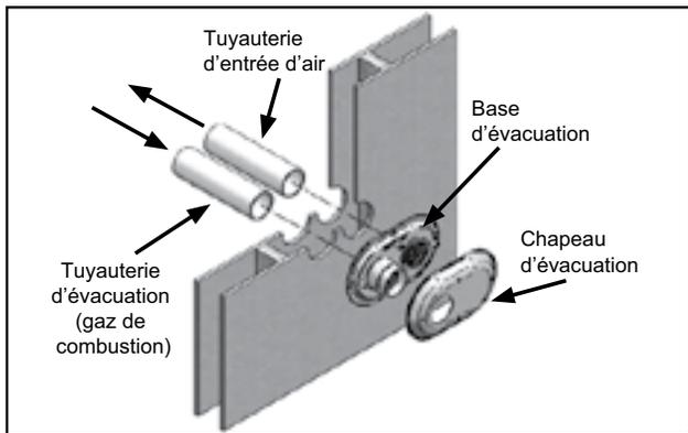
Figure 39. Flux d'entrée et d'évacuation dans les installations à bouche d'extrémité compacte
