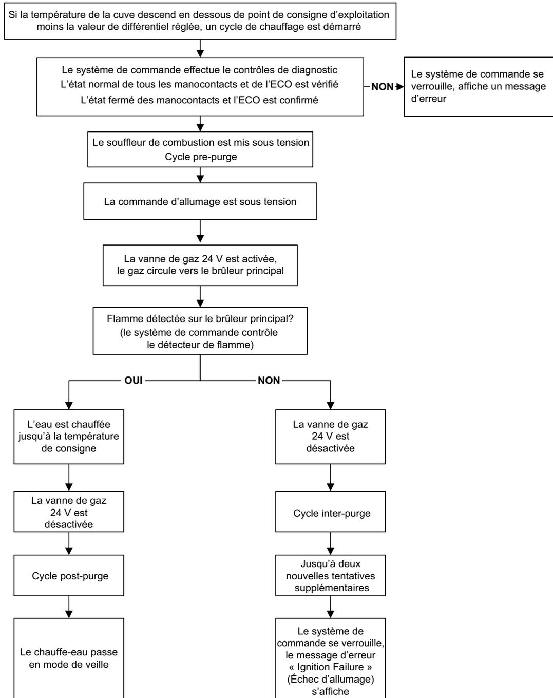
Figure 63. Séquence de fonctionnement
