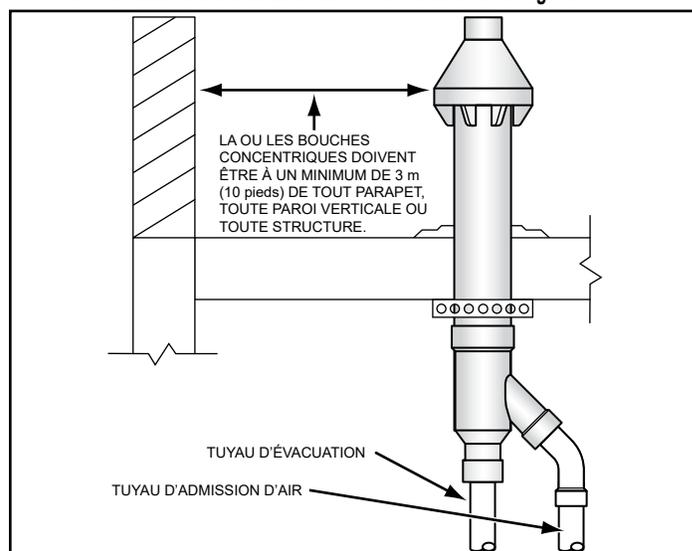
**Figure 27. Extrémité concentrique - Dégagement sur toit plat**
