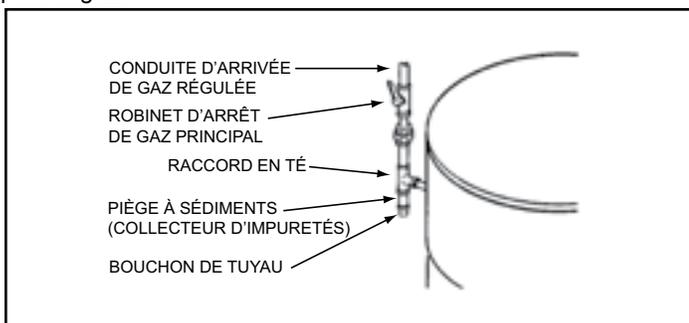
**Figure 54. Installation de la conduite d'arrivée de gaz**
