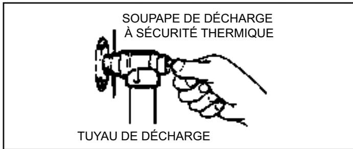
Figure 67. Essai de la soupape DST
