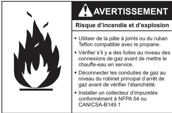
Lors de tout travail sur le système d'alimentation de gaz, effectuer des contrôles d'étanchéité pour éviter la possibilité d'incendie ou d'explosion.
