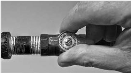
Figure 23 - Vanne de gaz manuelle en position ouverte.
