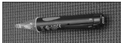
Figure 28 - Multimètre sans contact
