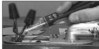
Figure 32 - Multimètre sans contact
