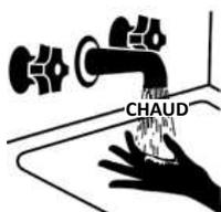
Les températures d'eau chaude supérieures à 52 °C (125 °F) peuvent causer des brûlures sévères instantanément ou la mort par l'échaudage. Les enfants, les personnes handicapées et les personnes âgées ont un plus grand risque de déchaudage. Tâter l'eau avant de prendre un bain ou une douche. Des limiteurs de température sont disponibles. Demander à un professionnel.
