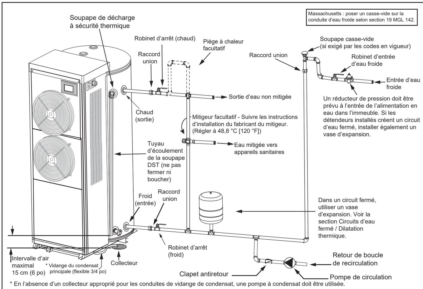
Figure 13. Tuyauterie du circuit d'eau complet
