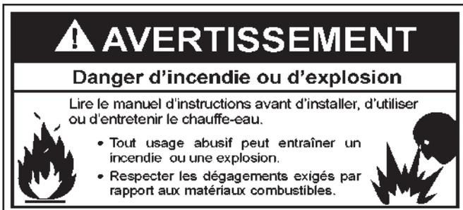
Les distances minimales par rapport aux matériaux combustibles sont indiquées sur la plaque signalétique à l'avant du chauffe-eau. Les dégagements standard sont de 0 mm (0 po) sur les côtés et l'arrière, de 0 mm (0 po) sur l'avant et de 0 mm (0 po) sur le dessus. Si les dégagements par rapport aux matériaux combustibles indiqués sur le chauffe-eau sont différents des dégagements standard, installer le chauffe-eau conformément aux dégagements indiqués sur le chauffe-eau.
