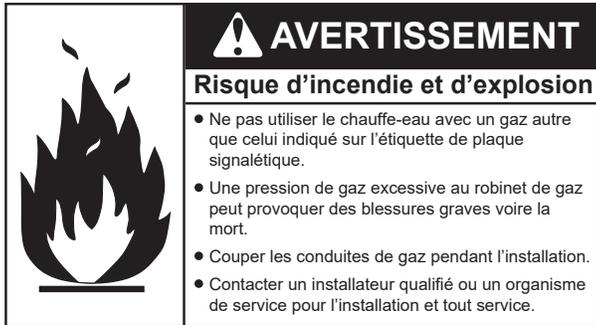
Si la pression du gaz d'alimentation vers le chauffe-eau ne se trouve pas entre les valeurs minimale et maximale requises indiquées dans la **Table 4** (page 11), ajuster le régulateur de gaz d'alimentation comme il se doit. Ajuster le ou les régulateurs de gaz d'alimentation en fonction des instructions du fabricant des régulateurs de façon à obtenir la pression de gaz d'alimentation « statique » et « dynamique » requise.
