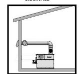
POWERED SIDEWALL W/DUCTED INTAKE
