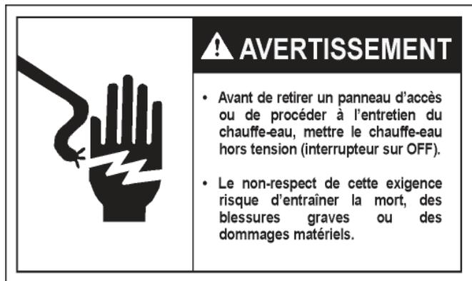
COUPER L'ALIMENTATION ÉLECTRIQUE (SECTIONNEUR) AVANT DE VÉRIFIER L'APPAREIL.
