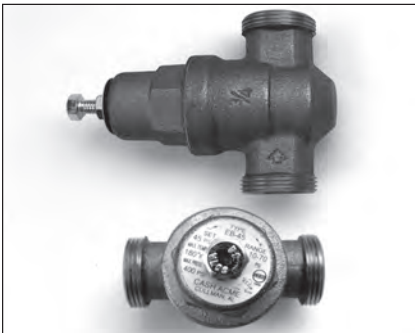
Figure 3 - Installer un détendeur réglé entre 345 et 414 kPa (50 et 60 psi).
