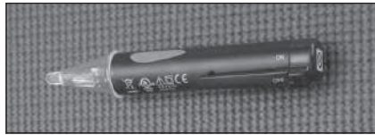
Figure 21 - Utiliser un contrôleur de tension sans contact pour vérifier l'alimentation électrique.
