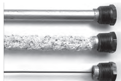
Figure 27 - Anodes neuve (haut), partiellement usée (milieu) et complètement usée (bas).
