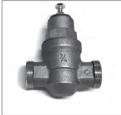
Figure 15 - Un détendeur est nécessaire si la pression d'eau de l'installation est supérieure à 552 kPa (80 psi).
