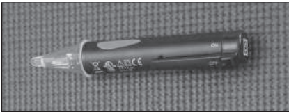
Figure 2 - Utiliser un contrôleur de tension sans contact pour vérifier que l'alimentation est coupée avant de travailler sur un circuit.
