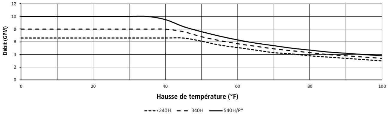
\*Débit maximal avec réglage supérieur à 55°C (130°F) est de 8,0 GPM.
