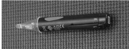
Figure 27 - Utiliser un multimètre sans contact pour vérifier l'alimentation électrique.
