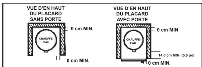
Figure 6. Dégagements minimaux par rapport aux surfaces combustibles
